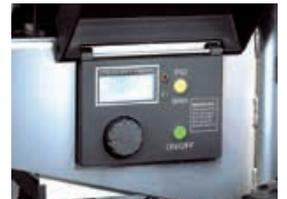
LCD螢幕可顯示即時的壓力值
