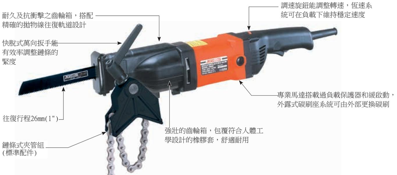
獨特的二合一式夾管組(選購)：一邊是供1/2"到8"管材固定用的鏈條，另一邊是專為較小管徑快速夾管設計之螺桿。切削時，此夾管組不但安裝更加快速且能提供4倍的槓桿力及90度完美直線切割。
