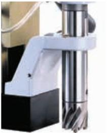
內銷主軸機型為鎖螺絲固定刀筒
